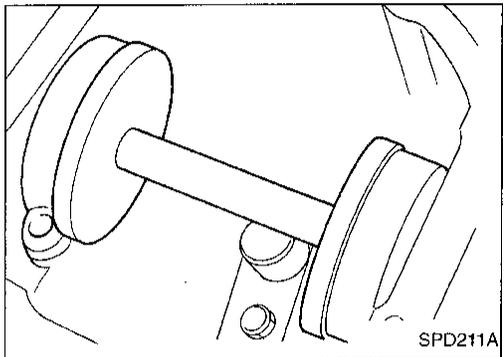
**PINION HEIGHT ADJUSTING WASHER SELECTION**
